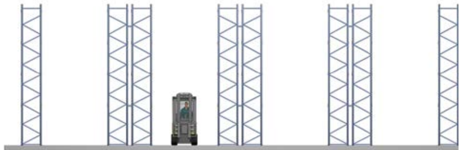
Sistema de rack selectivo más común formado por un rack sencillo adosado a la pared y racks dobles centrales
