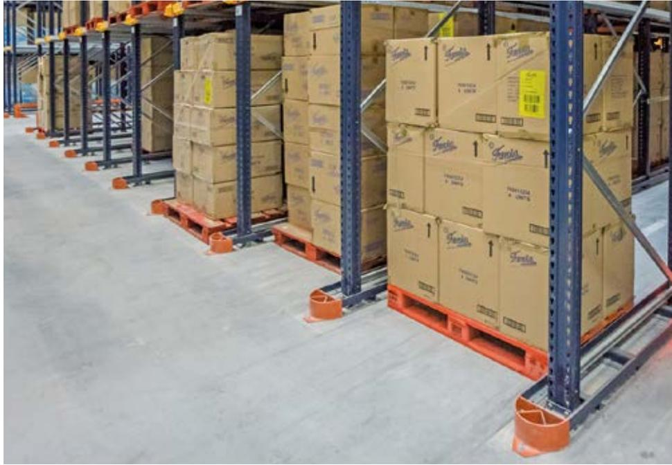
En las instalaciones donde se coloquen carriles guía hay que tener en cuenta que el ancho de calle se calcula en función de la distancia que necesite el autoelevador para moverse, más el ancho y holguras del perfil de los carriles. El sistema más usual es el que utiliza perfiles asentados sobre
