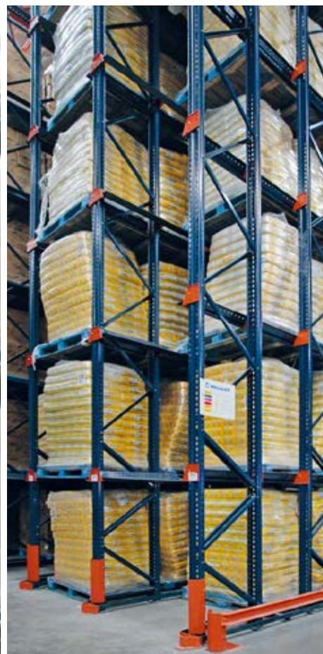
Los puntales utilizados como resultado de dichos cálculos se han desarrollado con geometrías específicas para cada tipo de instalación y cubren todas las necesidades de almacenamiento en función de la altura, la carga y la distribución de la instalación (figura 8).
